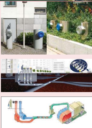
옥·내외 쓰레기 투입구 & 쓰레기 순환 시스템 개념도
